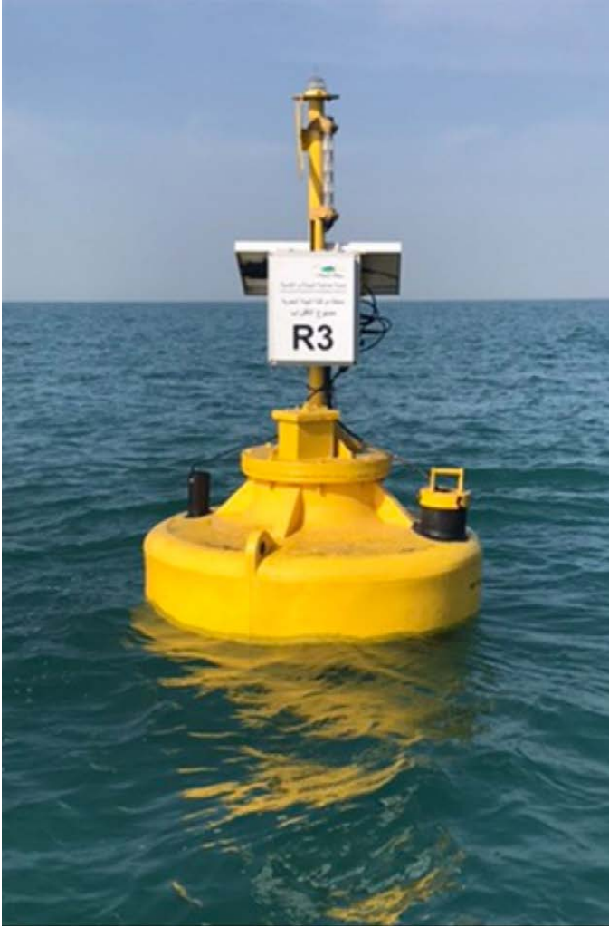
الشكل 14: جهاز قياس جودة المياه العائم المستخدم لمراقبة المؤشرات البحرية في رأس الخيمة
