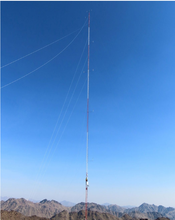
الشكل 23: سارية لقياس خصائص الرياح في وادي شوكة، رأس الخيمة
